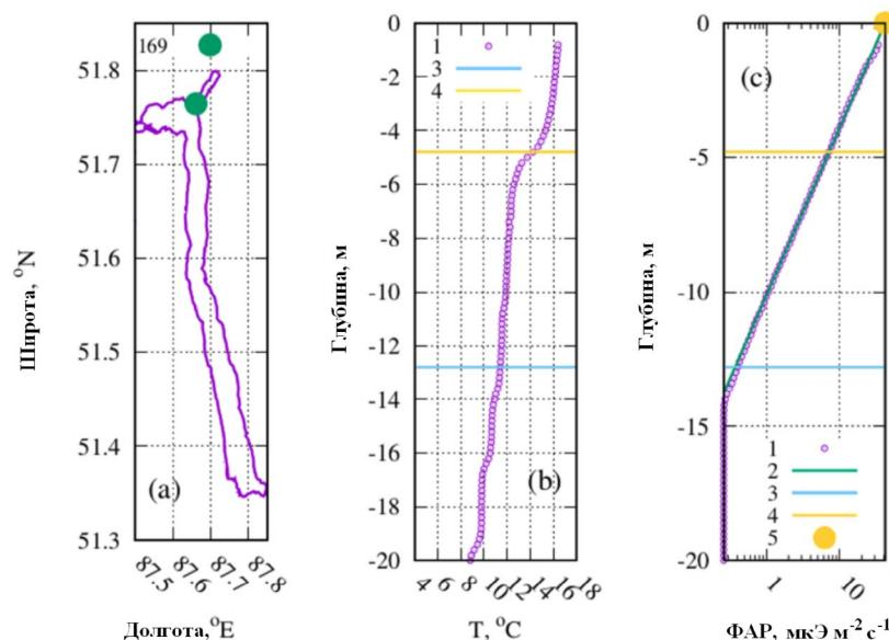
**Рис.2.** Пример одновременного измерения профилей температуры (b) и ФАР (c) прибором «КОНДОР» на ст. 169 района 1, выполненной 17 августа в заливе Камга (a), и результат обработки данных: 1 – поведение профиля измеряемого параметра; 2 – линейная аппроксимация уравнением (2); 3 – нижняя граница  $Z_{eu}$ ; 4 – нижняя граница ВКС; 5 – ФАР(0<sup>-</sup>).
